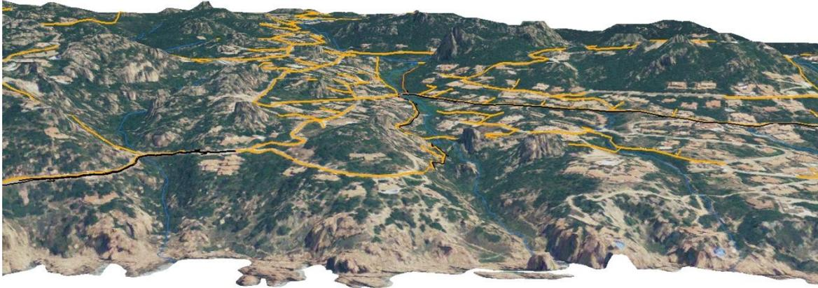
La figura mostra una vista tridimensionale dell'ambito in studio con evidenziati le linee di drenaggio e la rete di collettamento fognario.
